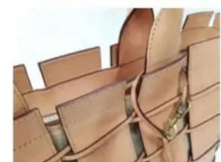
皮革の裁断面はすべて、職人が幾度も塗り重ねた「コバ塗り面」で仕上げられている。秀逸な作りの一面。
